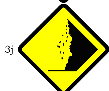
Peringatan Bagian Tepi Jalan Sebelah Kanan yang Rawan Runtuh
